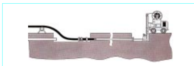
Figure 35 – Chemisage par tube préformé (d'après document Sade)
